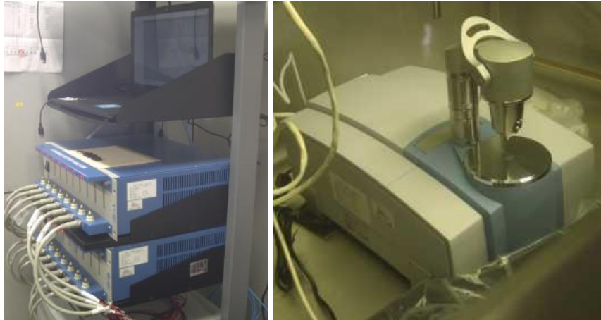
購入した充放電装置とグローブボックス内で使用できる小型赤外分光装置
